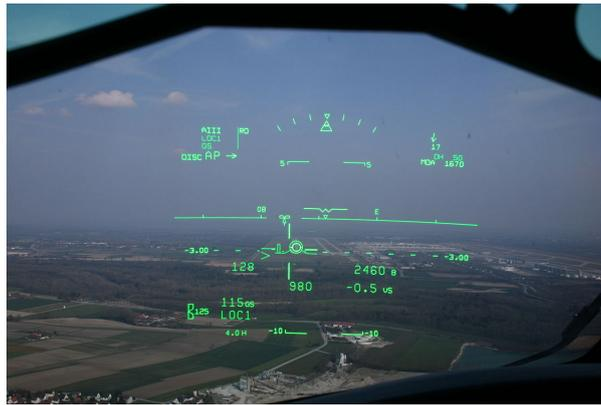
FIGURE 1 – Affichage tête haute d’un bombardier CRJ900
