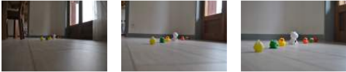
FIGURE 2 – 3 photographies différentes de la même scène prises en mode automatique avec un objectif de focale variable. La focale prend les valeurs 18 mm, 34 mm et 55 mm en allant de gauche à droite.
